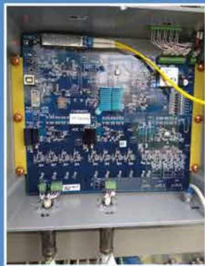
8. Модернизация систем тиристорного самовозбуждения генераторов мощностью до 70 МВт с применением микропроцессорного шкафа возбуждения с быстродействующим АРВ, заменой тиристорных преобразователей и шкафов силового ввода (производства РБ).
