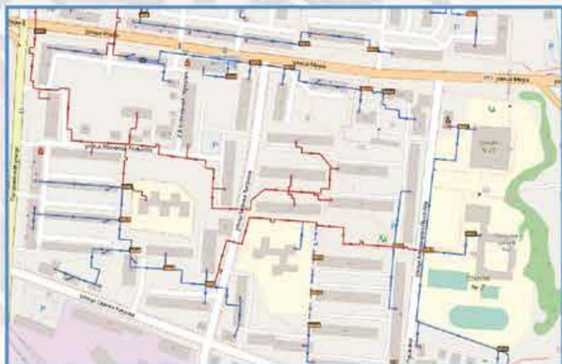
Пример электронной модели системы теплоснабжения на базе ГИС «ZULU-THERMO»
